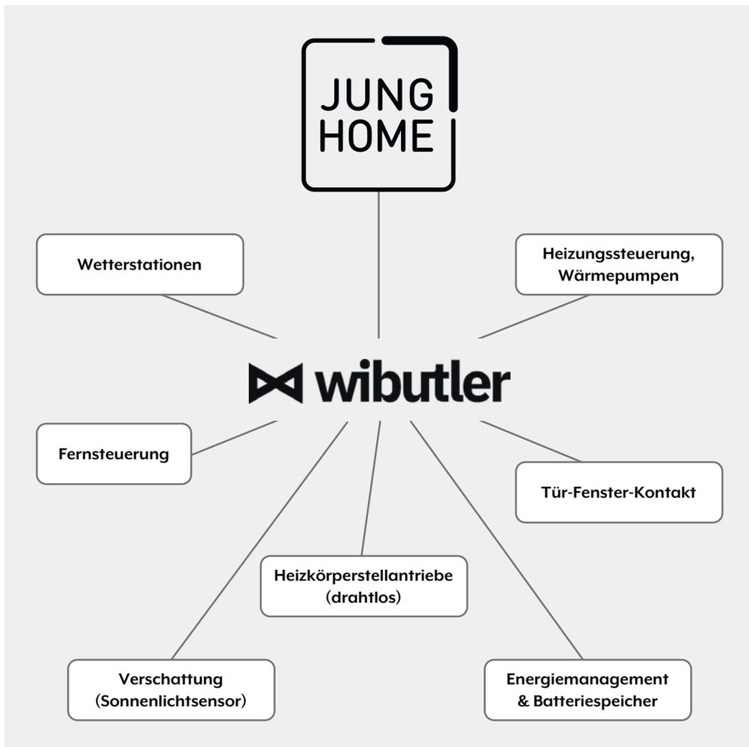
wibutler ist eine IoT-Plattform für die digitale Gebäudetechnik. Sie vernetzt und steuert über 300 Geräte von mehr als 40 Top-Marken, zum Beispiel Drehstromzähler von Eltako, Wärmepumpen von Viessmann oder Lüftungssysteme von Zehnder. Durch die Vernetzung des JUNG HOME Gateway mit einem wibutler pro rücken die Gewerke im Smart Home zusammen.
